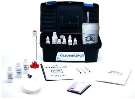
Figura 6.3 – Kit de potabilidade utilizado para análise de parâmetros físico-químicos e microbiológicos 1
